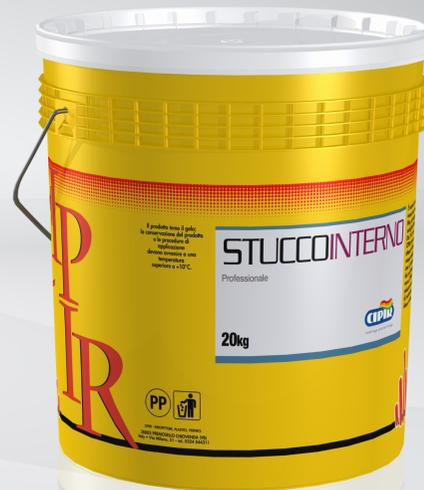
*Alto potere riempitivo, fine, carteggiabile ed elastico. Si presenta in pasta bianca e si applica a spatola. La velocità di essiccazione dipende direttamente dallo spessore dello strato applicato e dalla capacità di assorbimento della superficie trattata. In normali condizioni di temperatura ed umidità ed entro lo spessore di 1mm. è completamente asciutto in circa 1 ora. Prodotto pronto all'uso per rasare e stuccare legno e muri.*
